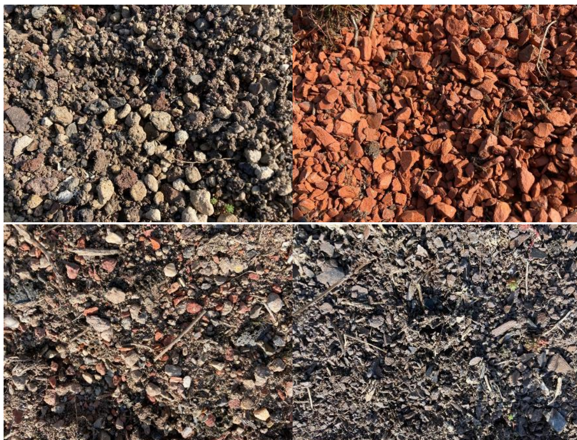
FIGUUR 7 DETAIL VAN DE VIER GEBRUIKTE SUBSTRATEN IN DEMO B (HELLING) EN D (BAKKEN GRONDNIVEAU). LINKSBOVEN: STANDAARD EXTENSIEF SUBSTRAAT; RECHTSBOVEN: ALTERNATIEF SUBSTRAAT 1; LINKSONDER: ALTERNATIEF SUBSTRAAT 2; RECHTSONDER: ALTERNATIEF SUBSTRAAT 3.
